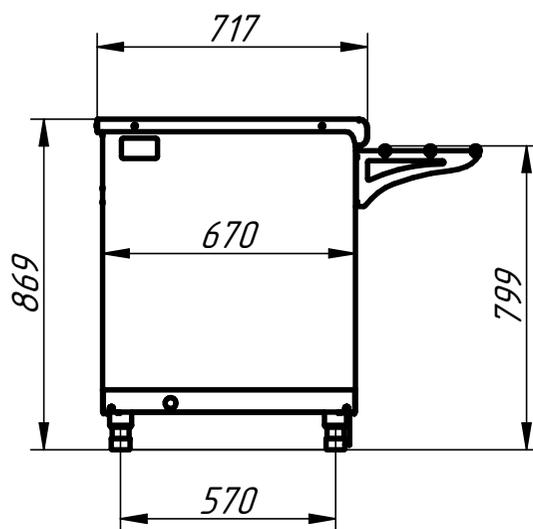
Модуль нейтральный служит в качестве нейтрального стола. Внизу нейтральный шкаф без дверей для хранения кухонного инвентаря. Модуль имеет регулируемые по высоте ножки. Направляющие для подносов входят в комплект поставки. С лицевой стороны ножки закрываются фартуком.
